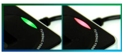
LED multicolor indica el estado y resultado del proceso
